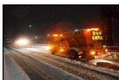
《路面凍結防止剤散布状況》
